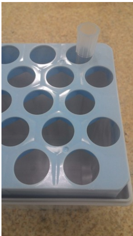
Fig. 5 – Rack incompatível com ponteiras marca Brand e Kasvi.
