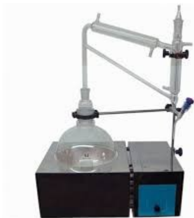
Fig. 1 - Vidraria e equipamento que fazem parte do Destilador para Oleos Essenciais Tipo Clevenger Modelo 553/5000.
